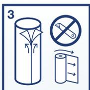
3 Les bobines ne doivent être retirées de leur emballage de protection que juste avant leur utilisation. Ouvrez la housse en utilisant la bande d'ouverture prévue. La flèche sur l'extrémité de la bobine indique la direction de l'enrubannage.
