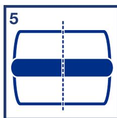
5 Die Baletite-Rolle muss mittig in der Aufnahme platziert werden, damit sich die Mitte der Rolle nach der Ballenmitte ausrichtet.
