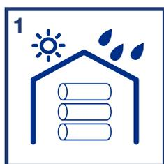
1 Baletite muss in der Original-Schutzsleeve-Verpackung gelagert werden. Die Rollen auf der Seite, trocken und geschützt vor direkter Sonneneinstrahlung lagern. Die Rollen müssen in der Sleeve-Verpackung gelassen und vor der Verwendung bei Raumtemperatur aufbereiten werden.
