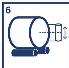
6 Applizieren Sie mindestens 2.5 bis 3 Lagen Baletite über die ganze Ballenbreite. Die Ballenverpackung (Stretchfolie), welche über Baletite angebracht wird, muss mindestens 50 % überlappen. Prüfen Sie sorgfältig, ob jede Schicht mit mindestens der Hälfte der vorherigen Schicht überlappt. 750 mm Folien sollten um mindestens 31 cm überlappen.
